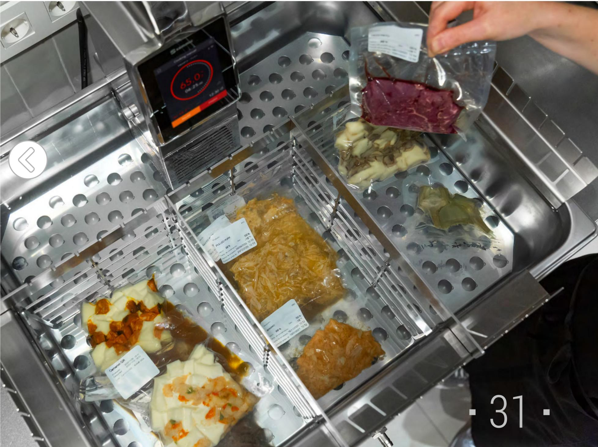
Die Trennwände ermöglichen die Unterteilung des Behälters und helfen, die Lebensmittel im Wasserbad besser zu organisieren. Es ist eine sehr praktische Art, den verfügbaren Platz optimal zu nutzen.
