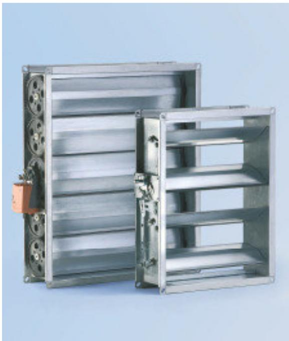
Jalousieklappen werden zur Druck- und Volumeneinstellung in lufttechnischen Anlagen eingesetzt. Alternativ dienen sie als Abschluß einer Luftleitung, um u.a. bei Stillstand der Anlage Kaltlufteinfall zu vermeiden. Alle Jalousieklappen gewährleisten bei sachgemäßer Anwendung und Montage die Dichtheitsklasse DK 2 nach DIN EN 1751.
